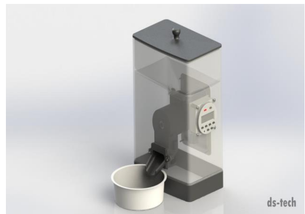
Зураг 3. Автомат нохой, муур хооллох машины эхний гаргасан 3D загвар (дотор механизм)
