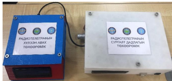
Зураг. 11. Морзын код үүсгэх болон хүлээн авч боловсруулах тоон төхөөрөмжүүдийн анхны бодит загвар
