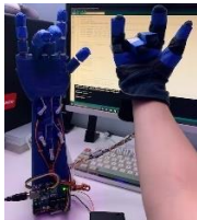
Зураг 5. Уян мэдрүүр ашиглан робот гар удирдах
