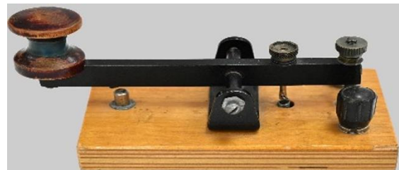
Зураг 3. Уламжлалт Морзын код үүсгэгч телеграфын механик түлхүүр
